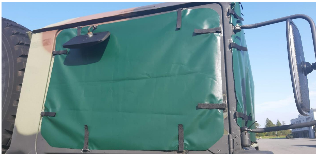
Foto 1. OÜ Lindante poolt 2020. aastal välja töötatud ja kuni 2025. aasta veebruarini toodetud pimenduskatete kinnitused. Katte materjal fotol pole õige, tegu on katseeksemplariga lõigete projekteerimise ajast 2020. aastal.
